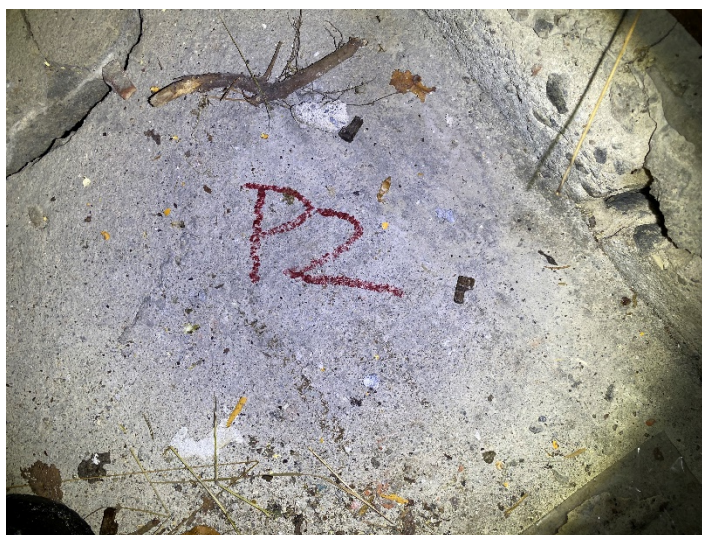
Figur 9: Prøvepunkt 2. Ubehandlet betong fra konstruksjonen er lett forurensete masser
