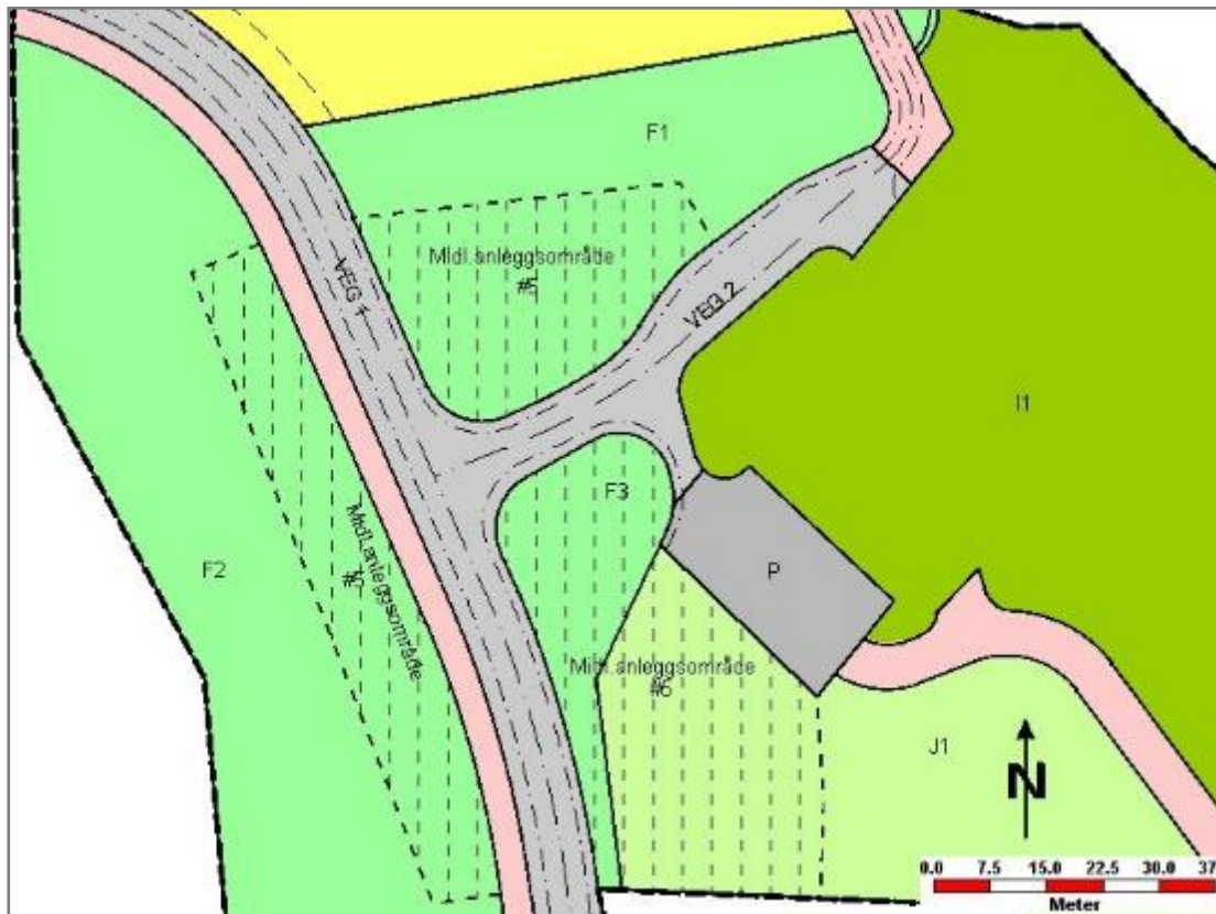
Figur 6.11 Eksemplet viser midlertidig bygge- og anleggsbelteområde. «#5» er metoden for å henvise til bestemmelser som gjelder for området.
