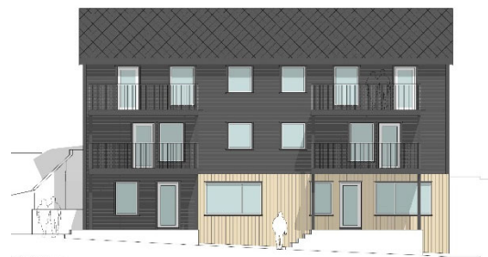
Planlagt ny fasade med trekledning og balkongløsning
