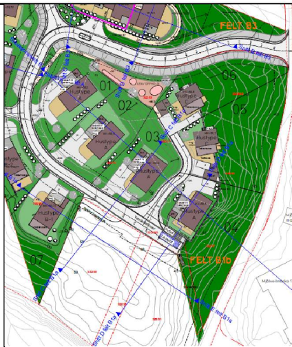
Figur 2 Utklipp utomhusplan med prosjekterte avkjørsler. Det er prosjektert 4 avkjørsler til feltet, altså 2 nye i forhold til regulert antall.
