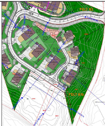
Figur 2 Utklipp utomhusplan med prosjekterte avkjørsler. Det er prosjektert 4 avkjørsler til feltet, altså 2 nye i forhold til regulert antall.
