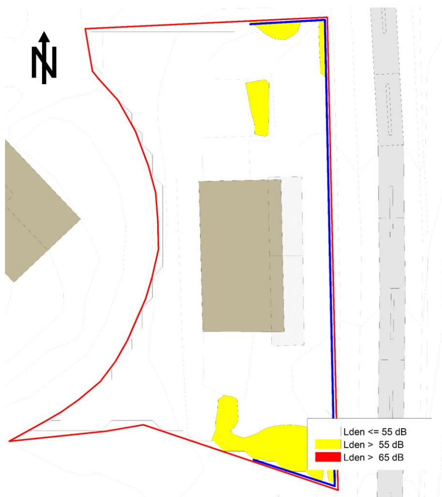
Figur 5: Beregnet lydnivå fra vegtrafikk i 1,5 m høyde over terreng med +2,0 m høy skjerm med samlet lengde 62 m langs tomtegrensen. Skjermens utstrekning er markert med blå strek.
