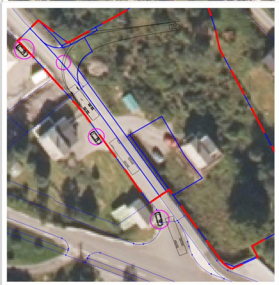
Figur 12 -Skissen viser at det finnes flere møtemuligheter langs første del av Fuglevikvegen og at planområdet kan betjenes av anleggsbiler uten å kjøre på fortauet. Illustrasjonen viser lastebiler med 12 meter lengde og 2.55 m bredde.
