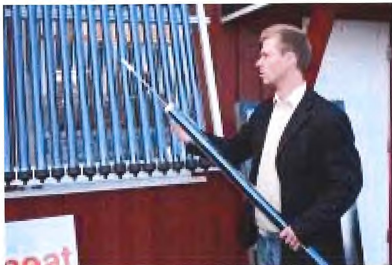
Slik ser solfangerrøra ut. Kvart enkelt kan byttes utan at anlegget må tappes ned.
