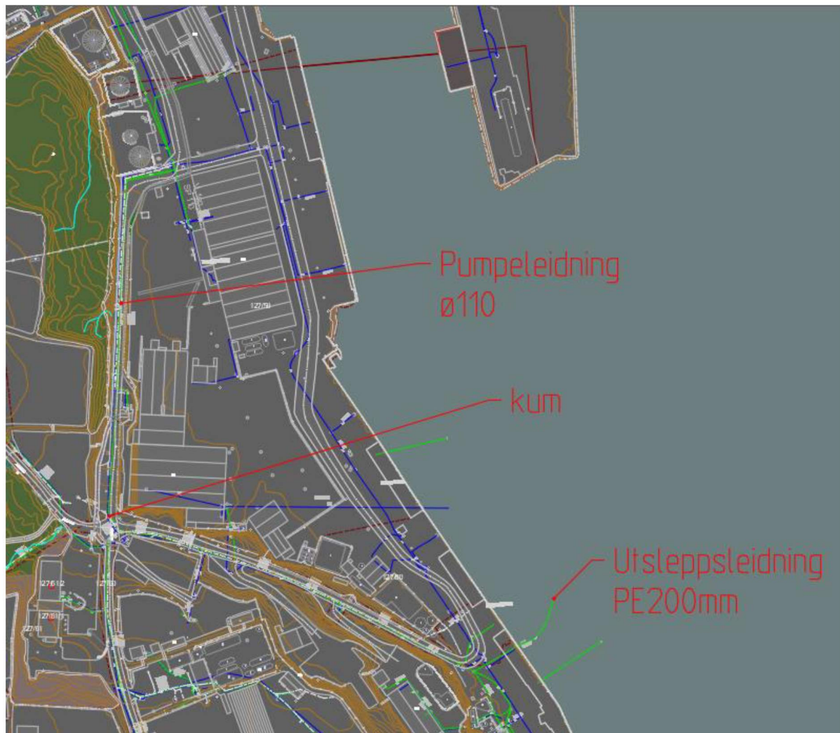
Figur 5: Pumpeledning og utslppsleidning
