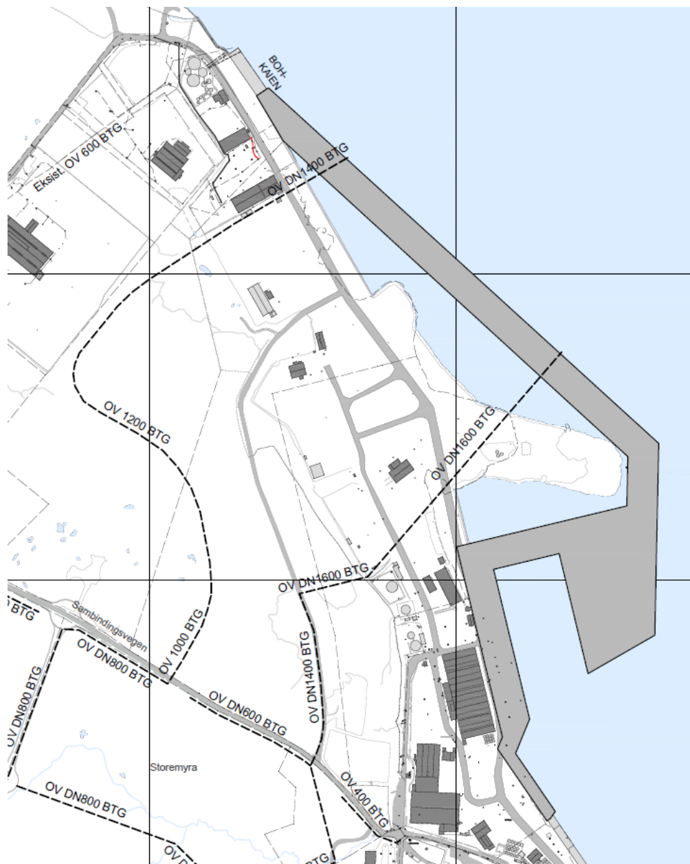
Figur 12: Planlagde overvassleidninger. Utsnitt av VA masterplan (ref. rapport frå Norconsult)
