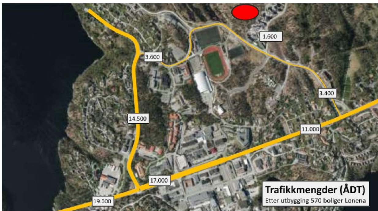
Figur 5: Trafikk etter utbygging av Lonena inkl. Langheiane. (ref. fig. 3 Samordnet trafikkanalyse. Rapport Siv.ing. Helge Hopen AS datert 02.05.2022)
