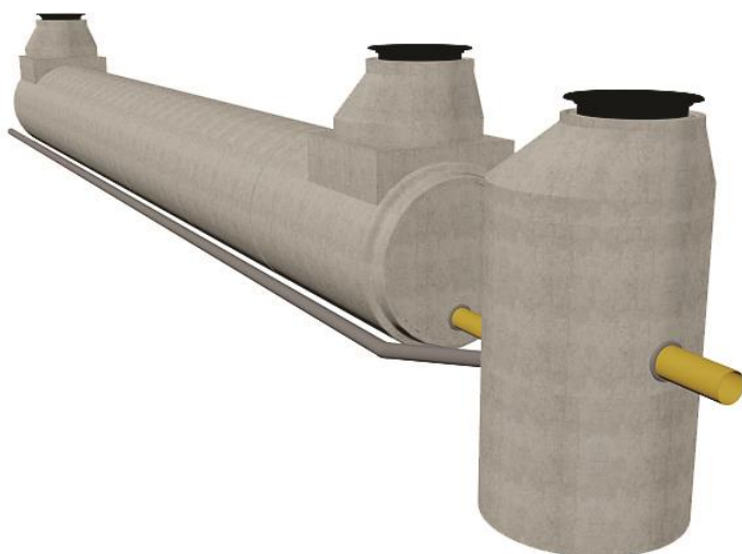
Figur 16, infiltrasjonsanlegg med fordrøyningsmagasin av betongrøyr.
