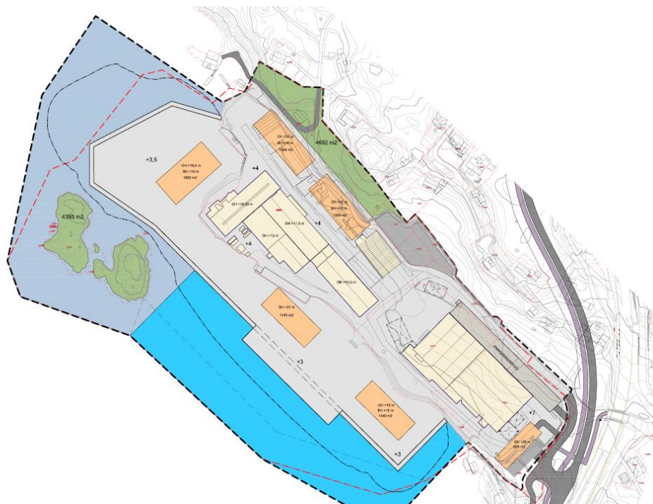
Figur 2: Planskisse som viser utvidelse av landareal og tilhørende fylling i sjø. Blått området sør for Gudmundsholmen viser ferdelsesområde i sjø tilknyttet planlagt kaiområde.
