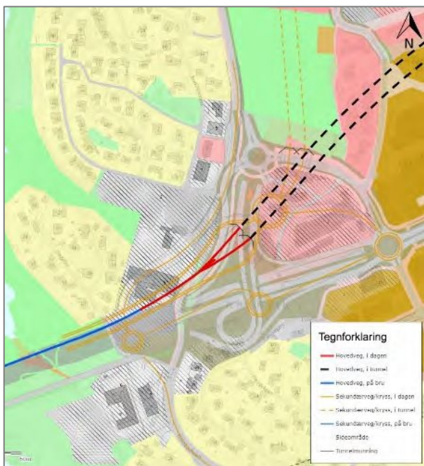
Figur 11. Alternativ V3 vist på arealplan viser kryssing av areal for kontor/industri (grå skravur) i dagsonen i Knarvik.
