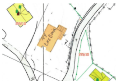
Tidlegare situasjon – dispensasjon gitt med minste avstand 7,5 meter frå vegmidt.
