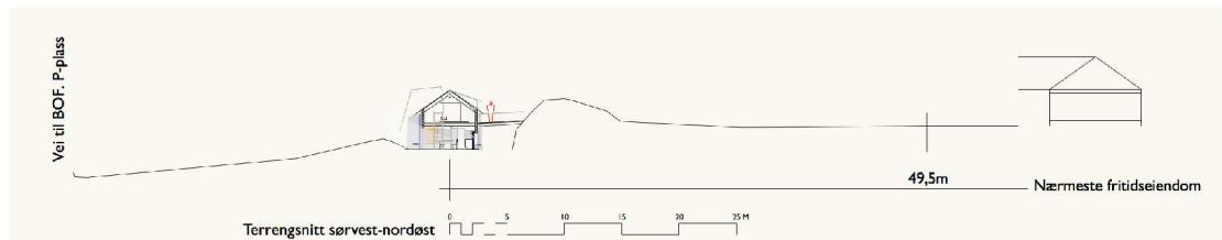
Det tenkes oppført en bolig med referanse i eldre byggeskikks sammenbygde bygningsform. En moderne 3-delt variant, her med en fullklimatisert frontdel på tilsammen ca. 55m<sup>2</sup> BYA, og et halvklimatisert grindbygg mot engen i sør, på 65m<sup>2</sup> BYA. Bygget tenkes i en etg., og med knevegger oppe på loftet under saltaket. Mønehøyde for hovedtaket, skisseres til 5,3m over adkomstens planerte terreng. Se vedlagte terrengsnitt og oppriss sett fra hyttene i nord.
