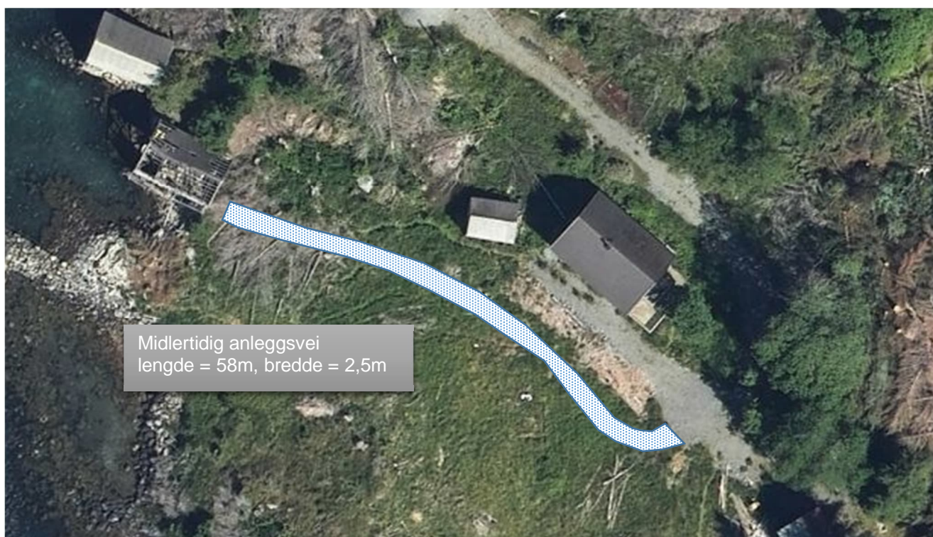
Figur 5: Midlertidig anleggsvei går langs eksisterende sti / vei
