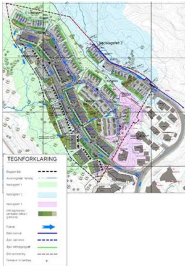
Figur 8-46: Handling av overvann etter utbygging. Illustrasjonen viser nedslagsfelt, avrenningslinjer og flomveier. Kjelde: Haugen VVA.
