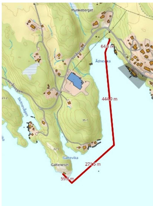
Ved evt. tilkoping til offentlig vann- og avløpsløsning, vil trase for ledninger i sjø, fra Galteneset til Ådnevika bli ca. 850 m lang.
