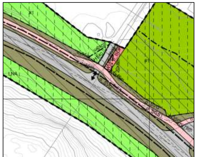
Justert GS-veg ved kryssingspunkt.
