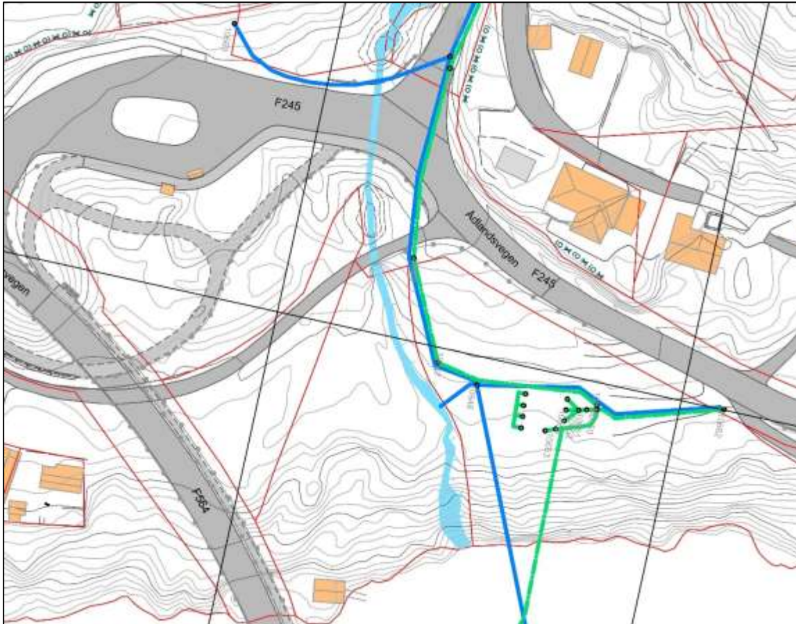
Figur 24: VA-anlegget i Fossevegen som fortsett ut i sjø. Vassledning synt i blått og spillvassledning synt i grønt. Kjelde: Teknisk plan.
