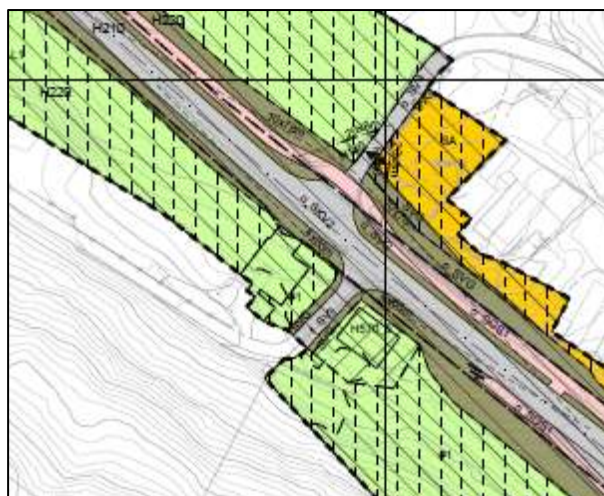
Justert GS-veg ved krysningpunkt samt lagt inn et punkt for tilrettelagt kryssing.
