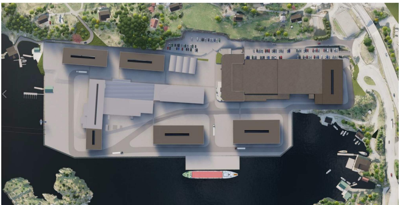
Figur 2-5. Illustrasjon av planlagte bygg og utfylling sett ovenfra. De nye bygningene er vist med brun farge i illustrasjonen fra VR modellen, mens bygninger som skal brukes videre er vist med grå farge. Illustrasjon: Multiconsult
