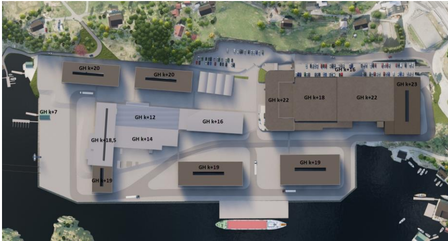
Figur 6-4: Illustrasjon som viser planområdet sett ovenfra med markerte høyder på eksisterende og planlagte bygg i området. GH betyr gesimshøyde, og oppgis i kotehøyde meter over havnivå. Kilde: Multiconsult
