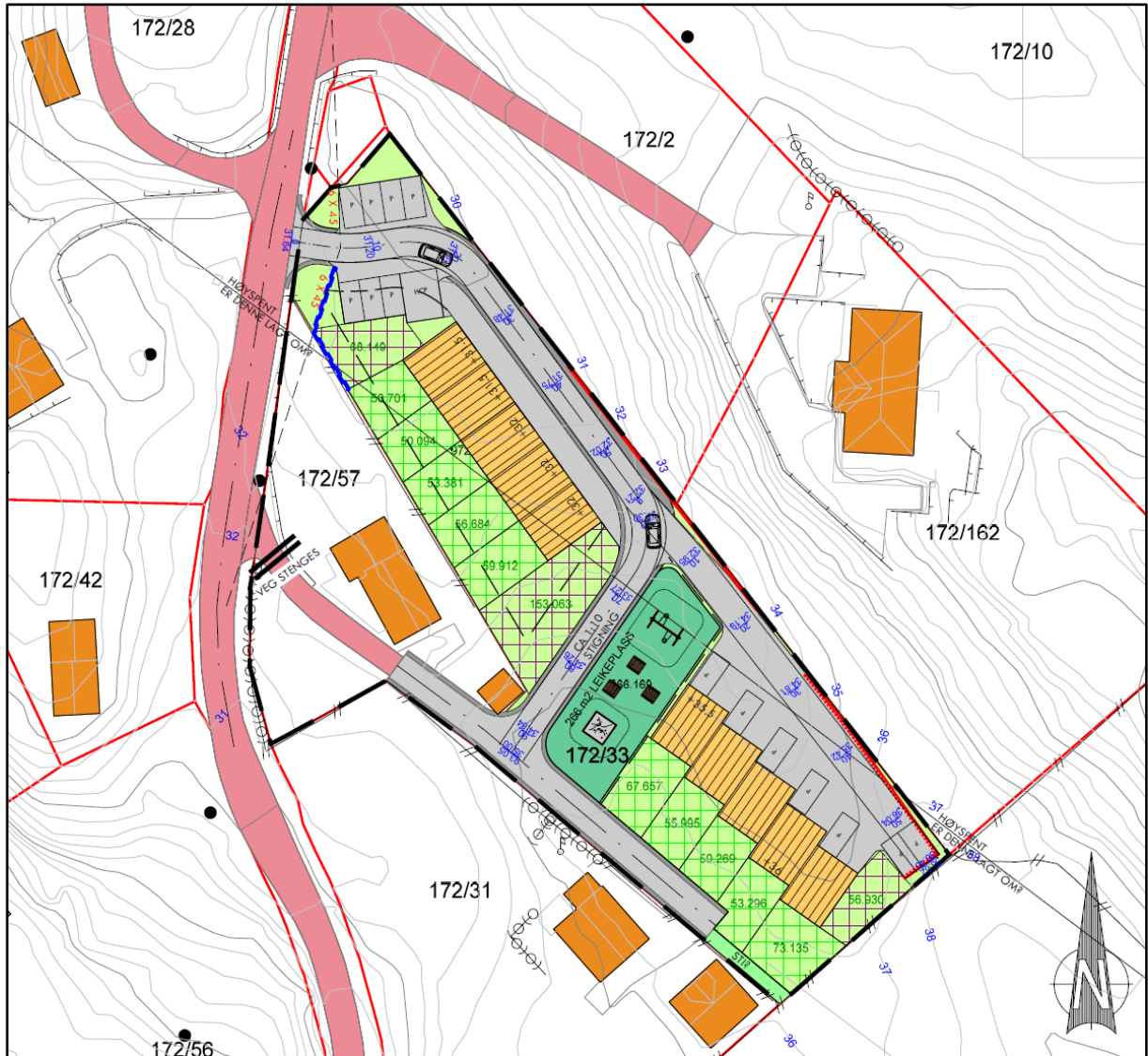
Figur 8 Illustrasjonen viser 2 rekkehus med 5 bygg i hver rekke og tilhørende parkeringsplasser og uteoppholdsarealer. Lekeareal er illustrert med 266 m 2 .
