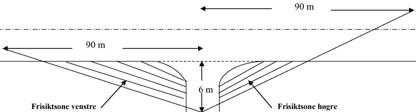
Tilsvarande sikt lengder som vist på tegningen må også gjerast gjeldande for trafikken som kjem på hovedvegen og skal inn i krysset (sikt bakover og framover langs hovedvegen)
