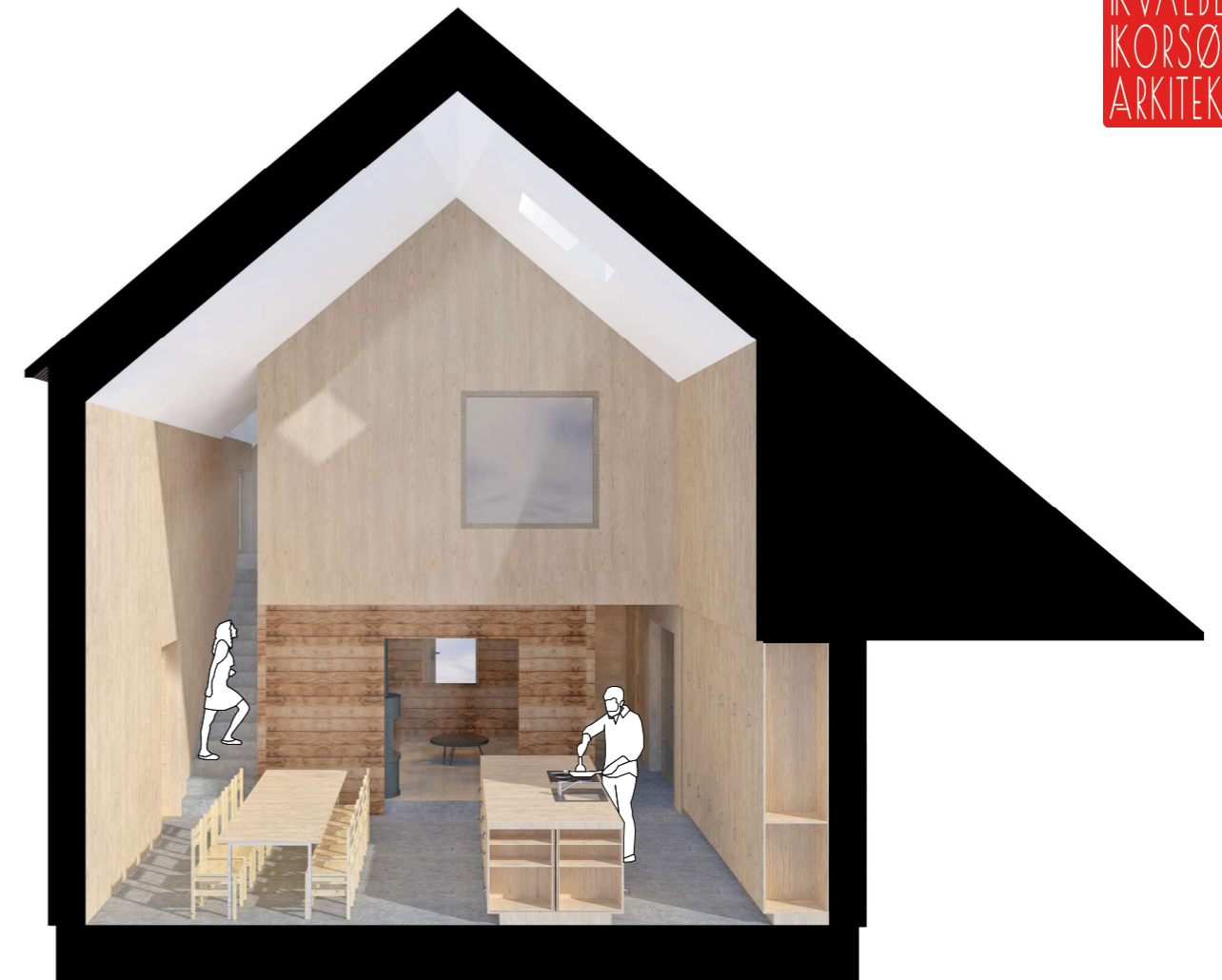
Kjøkken, trapperom, entre. Varm stue i rehabilitert tømmerkasse midt i huset
