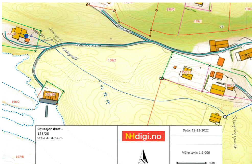
**Vedlagt kart viser plassering av slamavskiljar, filtergrøft og trase for vassleidning**
