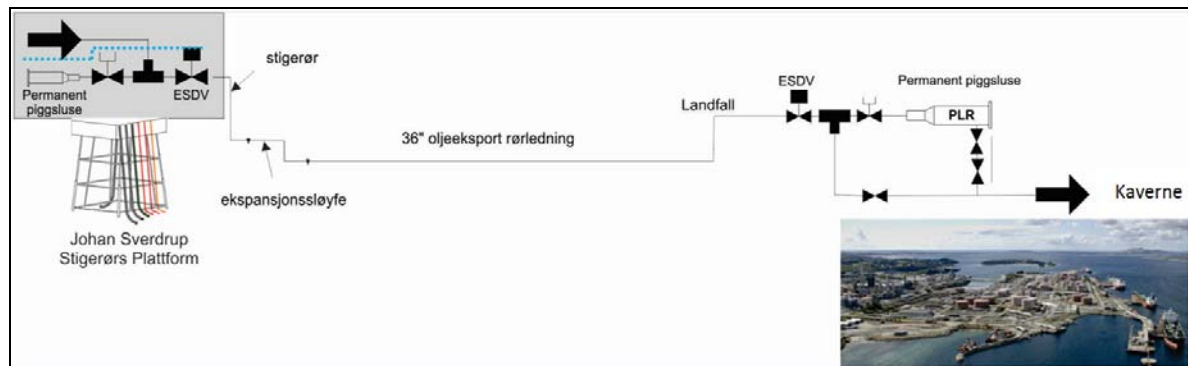
Figur 2-4 Prinsippsskisse for Johan Sverdrup oljerørledning til Mongstad terminal
