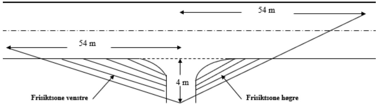
Tilsvarande sikt lengder som vist på tegningen må også gjeraast gjeldande for trafikken som kjem på hovedvegen og skal inn i avkjørsla (sikt bakover og framover langs hovedvegen)
