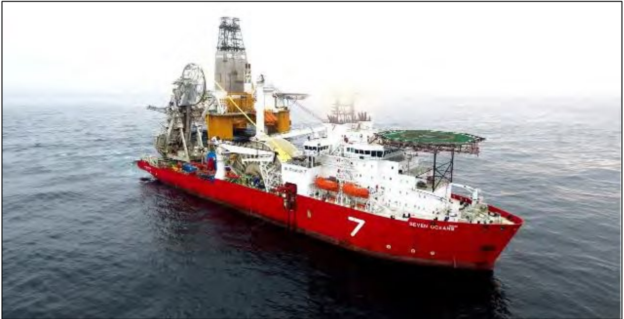
Figur 3. Bilde av spesialskip for legging av røyrledning.
