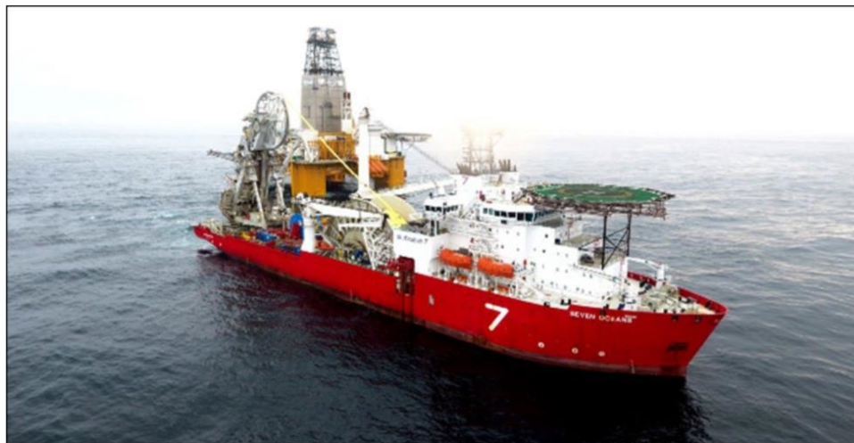
Figur 5. Bilde av spesielskip for legging av rørledning.
