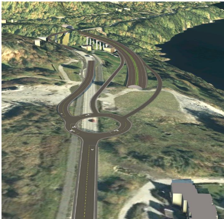
Figur 32 Døme på halvt kryss med austvendte ramper ut på ny bru ved Gjervik til E39.
