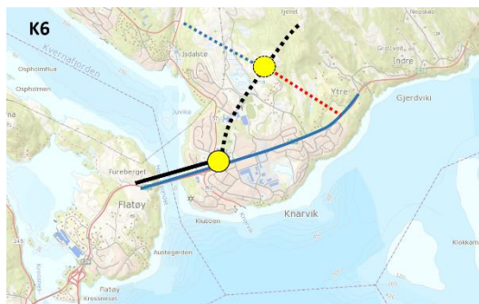
Figur 26 Fullt kryss i fjell mellom diagonal frå Isdal mot Gjerвик og E39 mot Hjelmås
