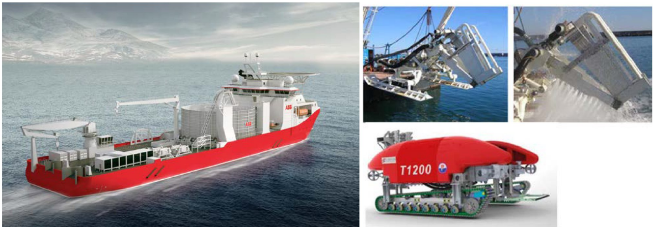
Figur 1 Leggefartøyet ABB «Victoria» og utstyr for ned-spyling av kabler
