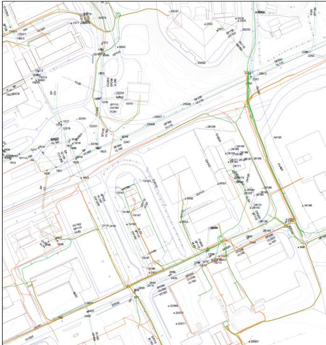
Figur 5 - Eksisterande kablar og VA-leidningar.
