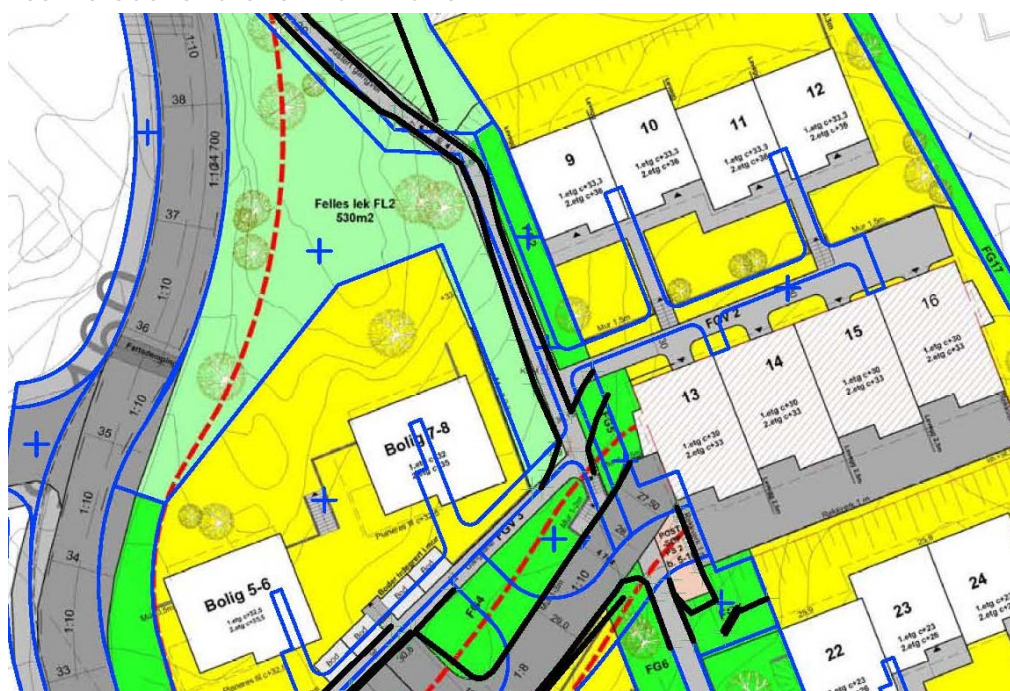
Fig 9. Innmålinger (svart) viser noe endret utforming i forhold til gjeldende utomhusplan. Følgende endringer bør inkorporeres i utomhusplan og må avklares med kommunen: Felles gangadkomst til husrekke 9-12 og husrekke 22-25 (se hhv fig 10 og 11). Endret utforming på FGV2 og FGV3 i forhold til omkringliggende grøntarealer (se fig 12 og 13). Avgrensning av PS2 og angivelse av mur sørøst for denne (se fig 14).
