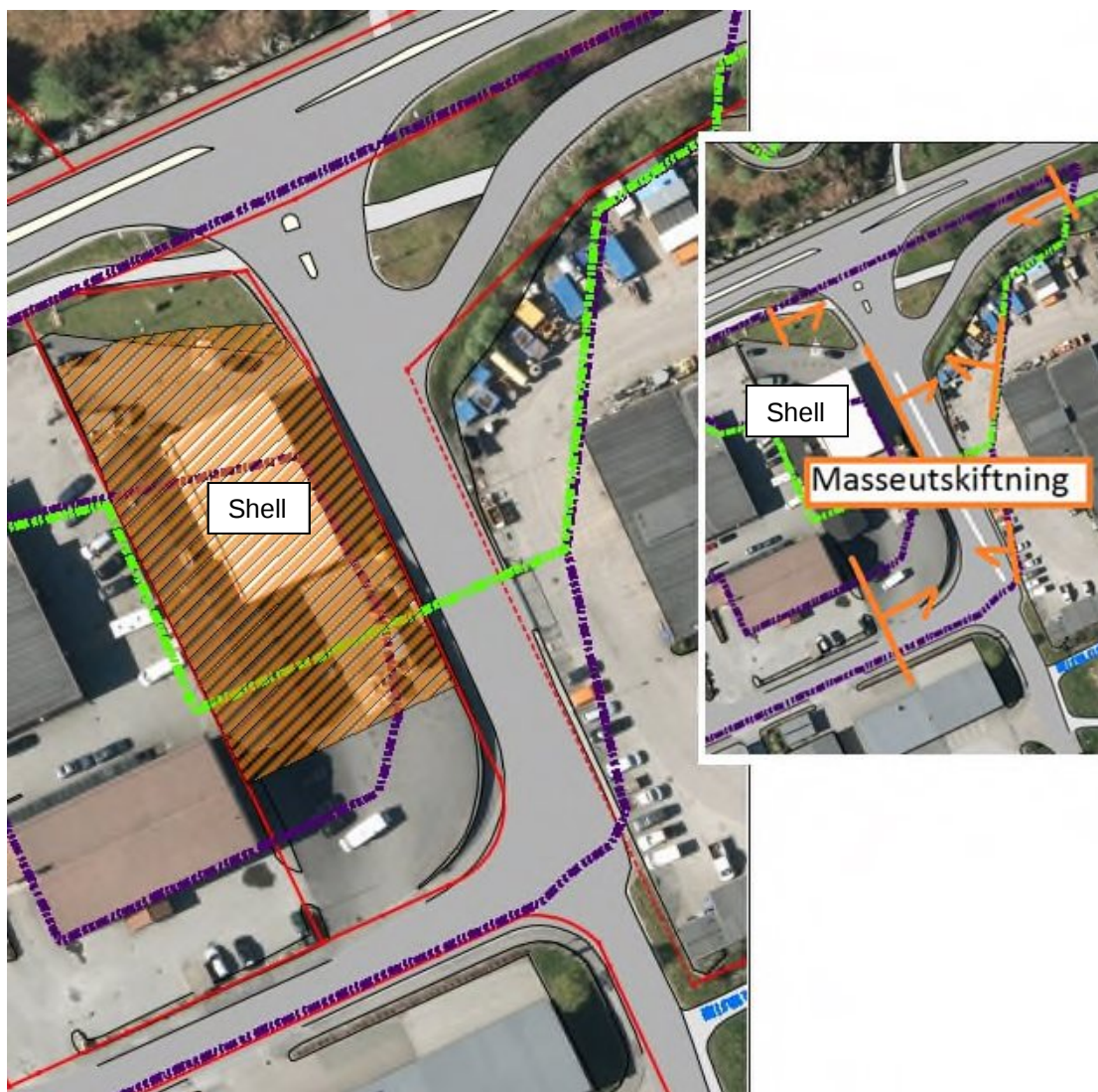
Figur 5. Området rundt Shellstasjonen, inklusivt tankanlegg og alt tilhørende infrastruktur, forutsettes fjernet og håndtert av Shell. Masseutskiftning på dette området er ikke medregnet i entreprisen eller beskrevet i denne rapporten. Det forutsettes at Shell tar hånd om alle forurensede masser på deres eiendom 4 ned til fjell eller påvist rene masser. Den største risikoen for alvorlig forurensning er angitt med oransje skraver. Området inngår ikke i det miljøtekniske underlaget eller i denne tiltaksplanen. Bilde til høyre: Masseutskiftning påregnes i området som er avgrenset av byggetrinn 1 og vist med oransje piler. Området er omtrent 5000 m 2 og varierer i dybde til fjell. I ytterpunktene angitt med oransje pil er dybden til fjell ca. 2 m, mens den dypeste målingen viser rett over 9 m løsmasser på fjell.
