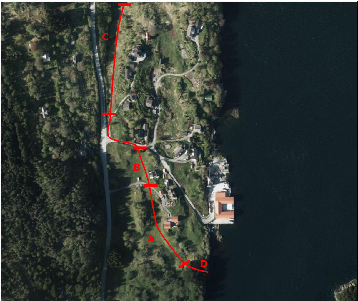
Fig. 15. Ortofotobilde som dekker tiltaksområdet ved Remme på Radøy. Trasé for ny vannledning er vist (se også plankartet i Fig. 11). Inndeling i soner A, B, C og D.
