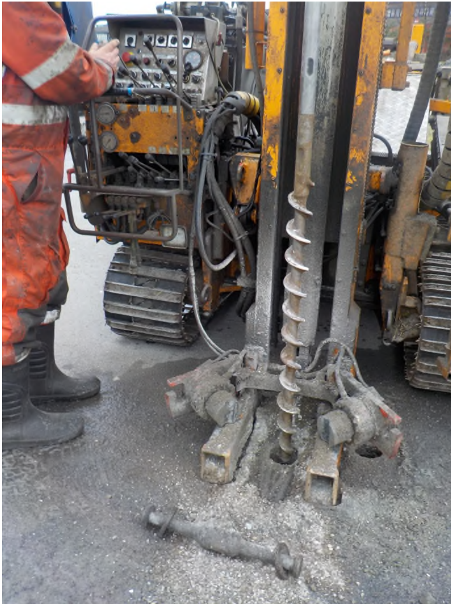
Figur 6. Prøvetaking med naverbor
