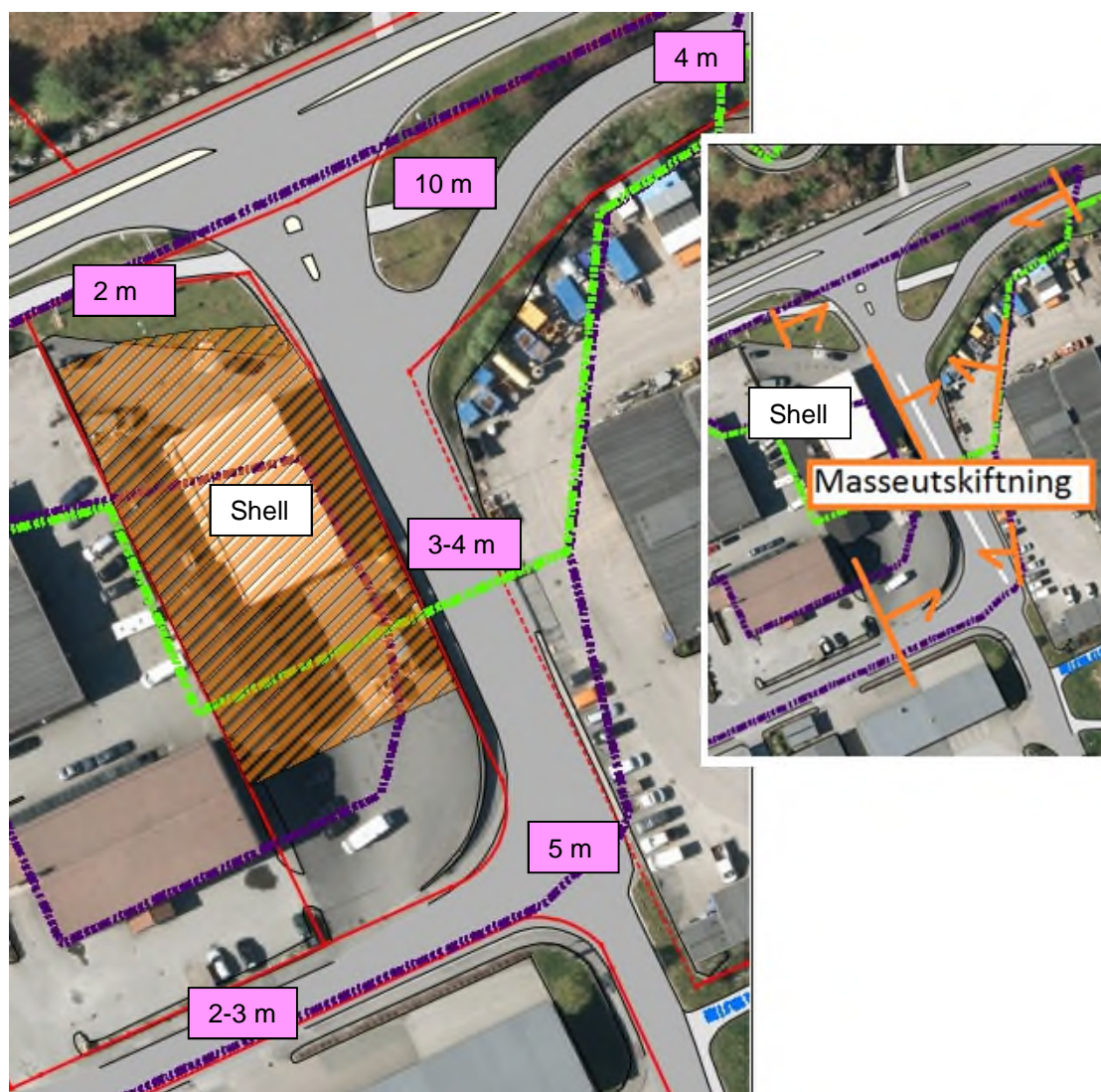
Figur 4. Området rundt Shellstasjonen, inklusivt tankanlegg og alt tilhørende infrastruktur, forutsettes fjernet og håndtert av Shell. Masseutskiftning på dette området er ikke medregnet i entreprisen eller beskrevet i denne rapporten. Bilde til høyre: Masseutskiftning påregnes i området som er avgrenset av byggetrinn 1 og vist med oransje piler. Området er omtrent 5000 m 2 og varierer i dybde til fjell. Omtrentlige fjelldybder er oppgitt i rosa tekstbokser.
