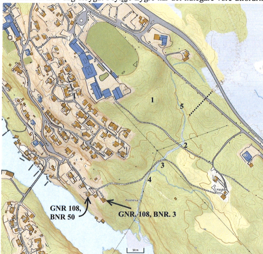
Fig. 1. Oversyn over situasjonen – nummer 1 er ca plassering barnehage, nr. 2-4 til bruer medan nr. 5 er ei ureiningspunkt. Den stipla lina frå myra og under vegen er der Presteelva er lagt i tunnel i samband med dyrkingsprosjekt på 60-talet. Kartkjelde: www.norgeskart.no
