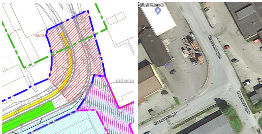
Fig. 1. Utsnitt fra faseplan 6, tilsvarende utsnitt fra Google Maps til høyre. Entreprensgrense for 1. byggetrinn vist med blå stipling, 2. byggetrinn med grønn stipling.
