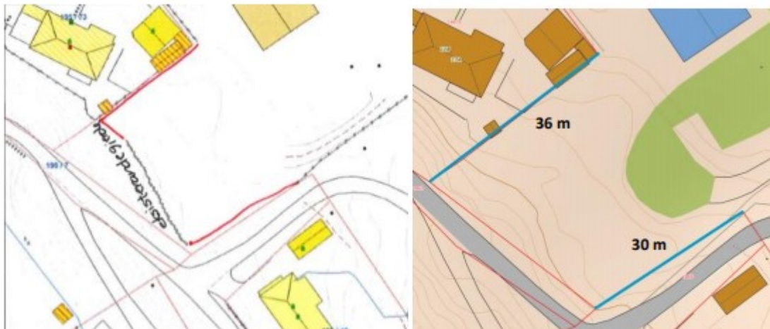
Bilde 4 – Plassering av gjerde mot 195/73 og 195/40.
