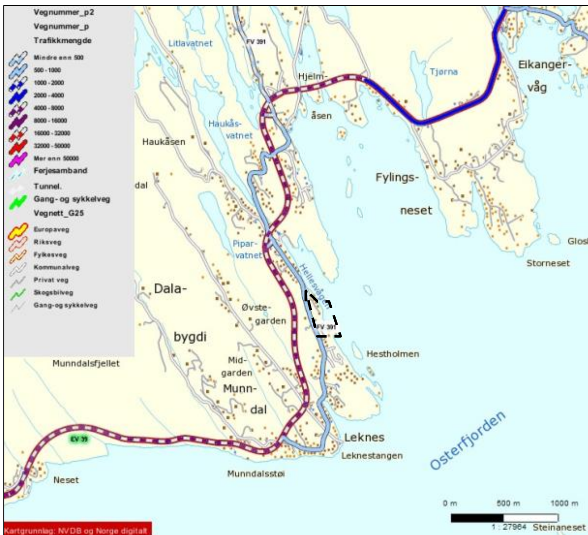
Figur 6.13. Statens vegvesen sin vegdatabank har oppført en ÅDT på 500 for fylkesvegen like vest for planområdet. E39 er oppført med ÅDT 4900. Planområdet innanfor stipla linje.
