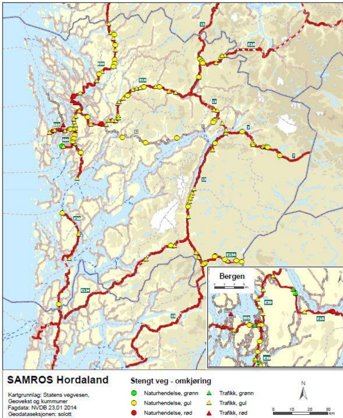
Figur 5.3: Hendingar som har ført til stengte vegar og trong for omkjøring
