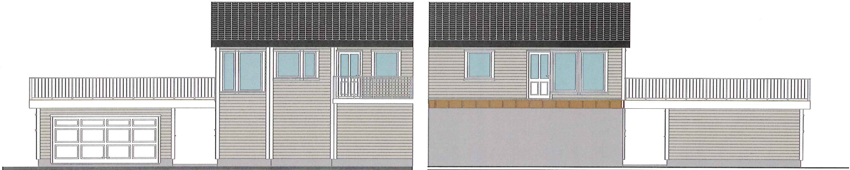
Garasje med sarnafil teknet terrasse.
