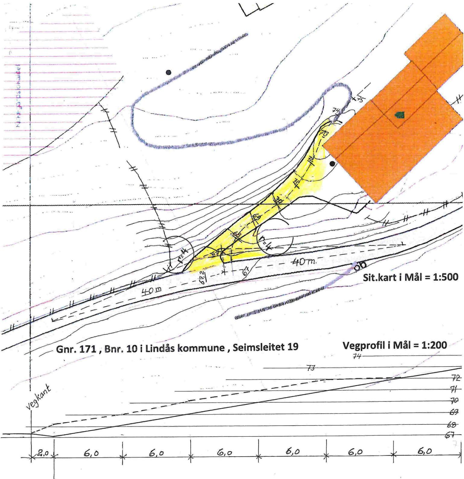
Det er i dag en høydeforskjell på 6 meter for en veglengde på ca. 36 meter, som gir en stigning på 1 : 6.
