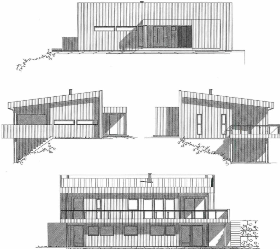
Det er lagt ved plan- snitt og fasade teikningar av bustad og garasje. For bustad er BYA opplyst til å vere 173,4m<sup>2</sup>. BRA 1.etasje er opplyst til å vere 96,7m<sup>2</sup>. Underetasje er opplyst til å vere 93,7m<sup>2</sup>. Samla BRA er 190,4m<sup>2</sup>. Mønehøgde er 6,2m. For garasje er BYA er opplyst til å vere 51,8m<sup>2</sup>. BRA er opplyst til å vere 48,8m<sup>2</sup>. Utrekna %BYA vert  $173,4 + 51,8 / 1510,2 * 100 = 14,9 = 15\%$  BYA.
