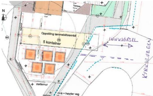
Endringa syner at grøntareal vert fjerna og innkjørsle vert no plassert over dette arealet. Gangveg vil få ei mindre justering, primært i front av bygg C. Vidare syner omsøkte endring plassering av 5 nedgravde avfallscontainere.
