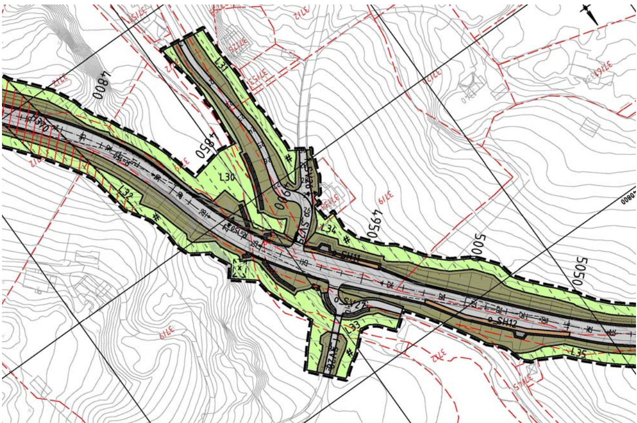
Figur 28: Løsning tilsvarende som fig. 27, men med kantstopp i staden for busslomme ved profil 4950. Alternativet er lagt til grunn for planforslaget
