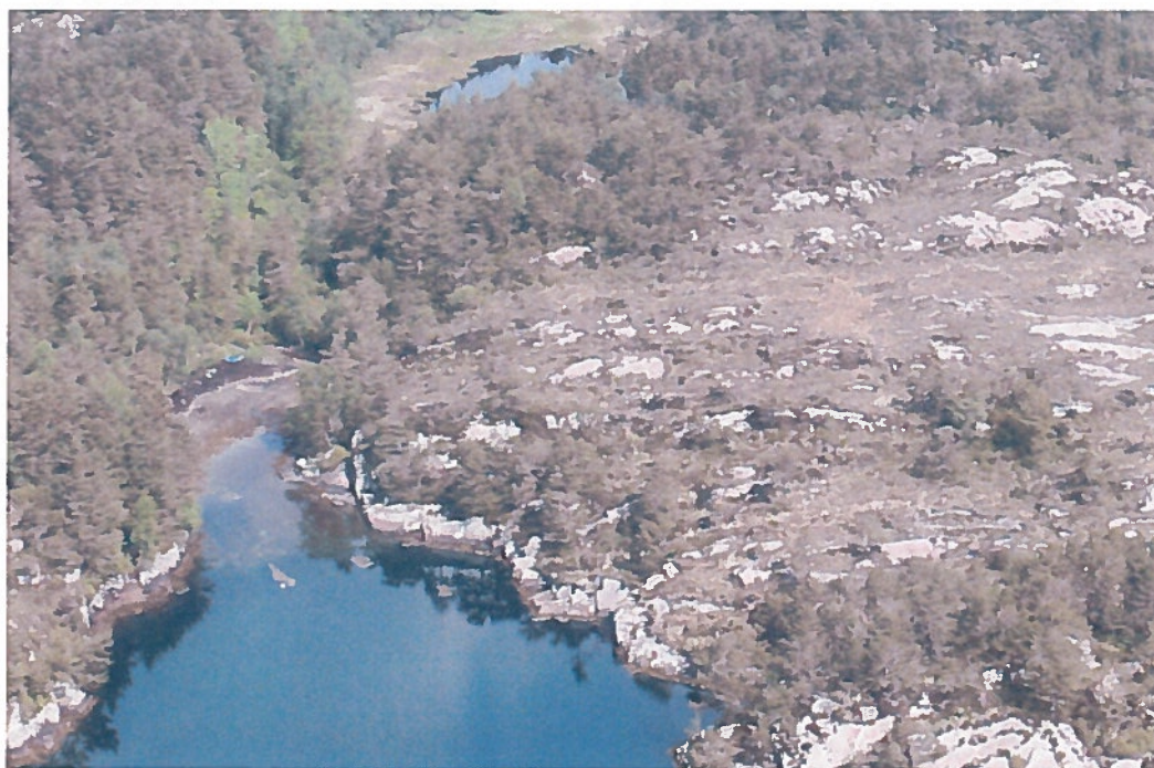
Figur 11. Iledalsvågen sett fra sør. Konsesjonsgitt kabeltrasé går opp over svaberget omtrent midt i fotoet, for så å gå i grøft over knausene og myren til høydedraget i bakgrunnen. BKK Nett søker nå om å i stedet la kablene gå helt inn til enden av vågen, for så å vinkle gradvis mot høyre (øst) i det skogklede området i bakkant av høydedraget.
