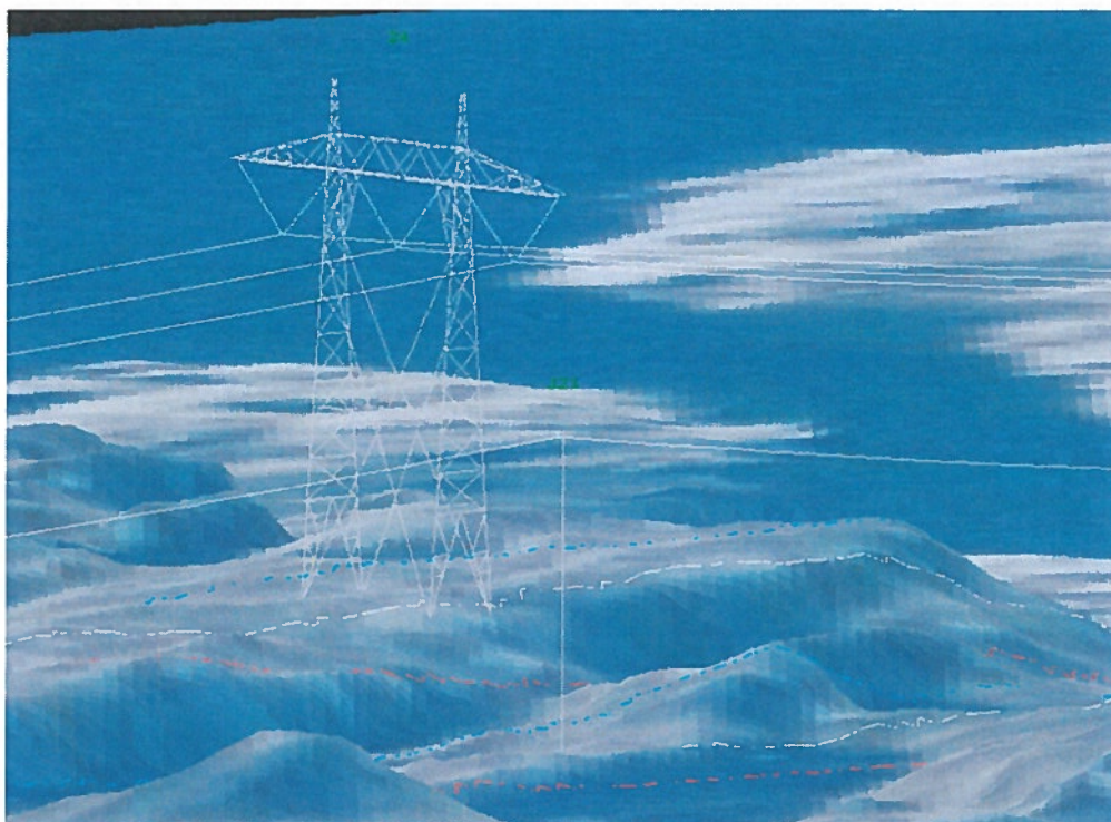
Figur 9. Perspektivtegning som viser stolpe for jordline med mast for 420 kV ledningen i bakgrunnen. Mastene for 420 kV ledningen blir uten spir på strekningen hvor jordline fremføres på egen stolperække, selv om modellen viser mast med spir.
