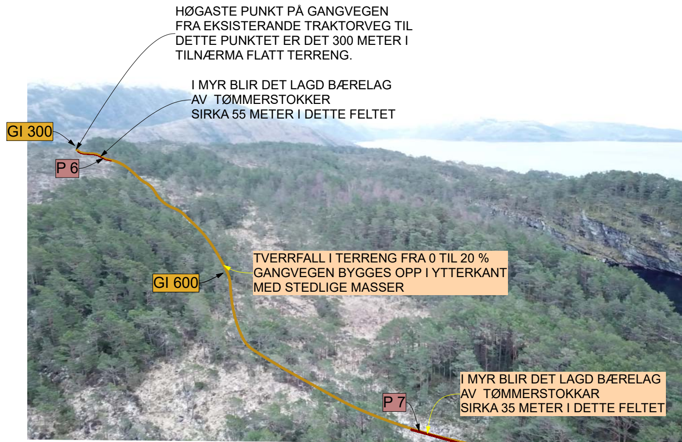
BILDE 1: DRONEFOTO SOM SYNER TERRENG FRA HØGSTE PUNKT PÅ GANGSTI (GI 300) TIL 100 METER FRA DAGSTURHYTTA. GANGVEG ER VIST MED ILLUSTRASJON I BILDE
