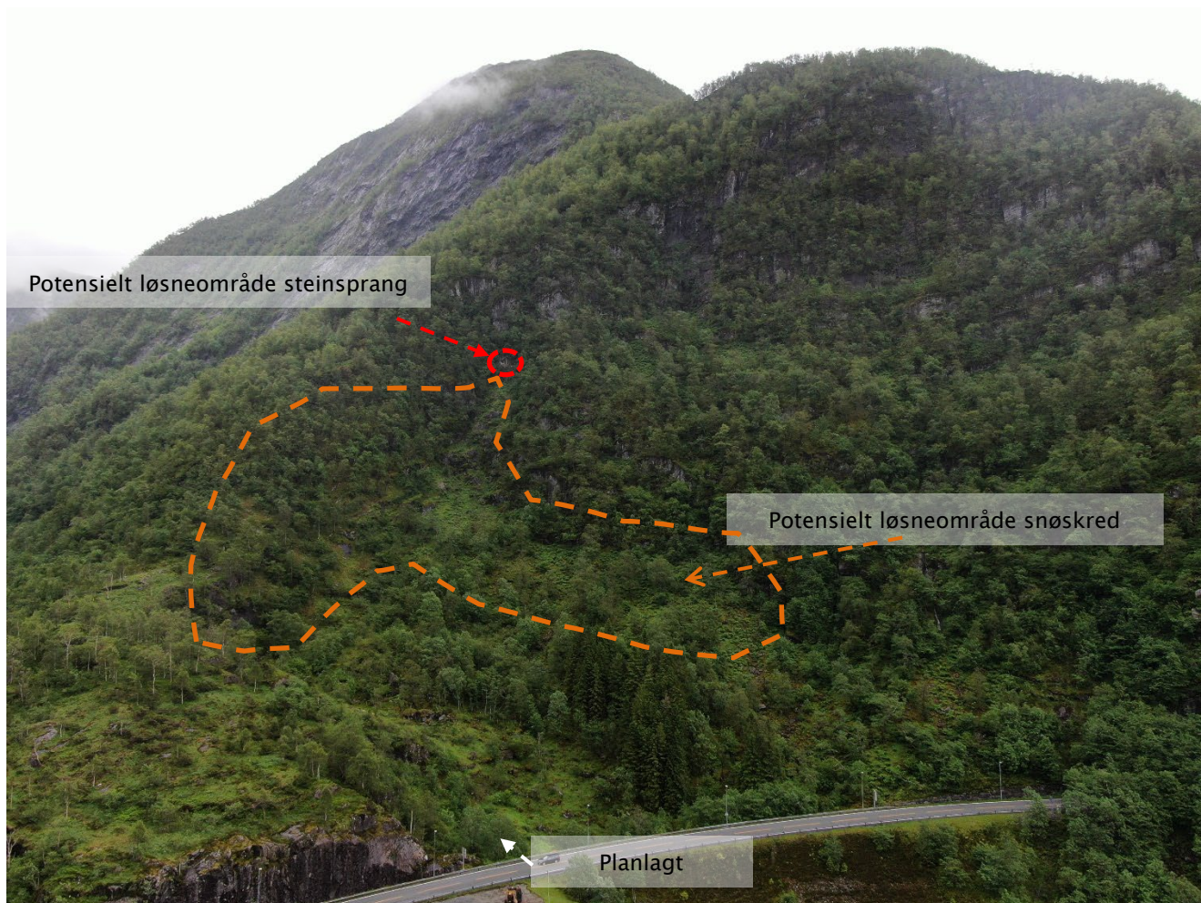
Figur 8: Rød markering viser mulig løsneområde for steinsprang. Orange markering viser omtrentlig område hvor det er mulighet for utløsning av snøskred i undersøkt område nær planlagt snuplass. Dette området har helning mellom 30-45 grader. Foto: Marianne Kjøllesdal Sundal
