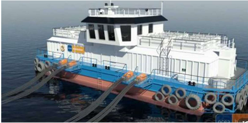
Bilde 1 Skisse av fôrflåten som vil kome ved anlegget, Ocea 300. Lengde: 22 m Bredde: 10 m
